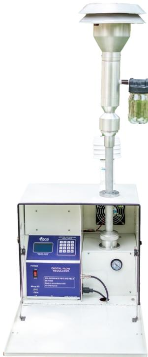
El muestreador de bajo volumen provee una plataforma flexible para el muestreo de partículas PTS, PM10 y PM2.5, así como el monitoreo de parámetros meteorológicos.
